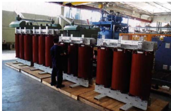
Transformatorer i fabriken, före leveranskontroll Transformers in workshop, before the final test
